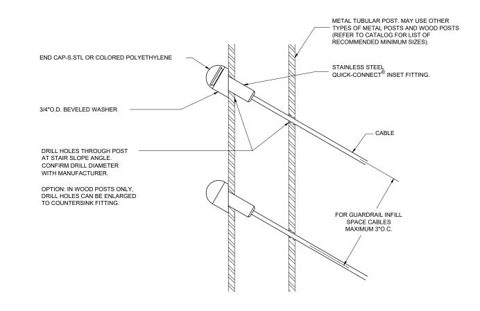
QUICK-CONNECT<sup>®</sup> INSET FITTING - ANGLED TERMINATION ON METAL POST
